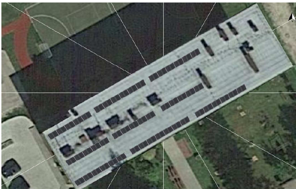
Fot.3. Lokalizacja i intensywność paneli fotowoltaicznych na połaci dachowej
